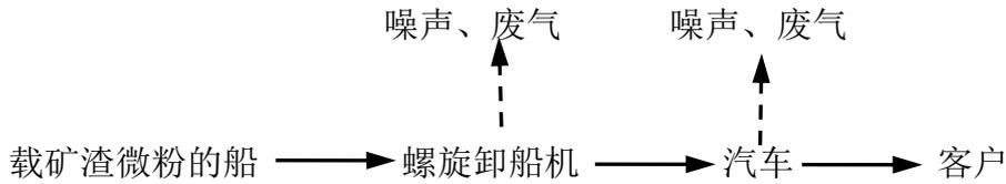
图 2-2 生产工艺流程及产污环节图
